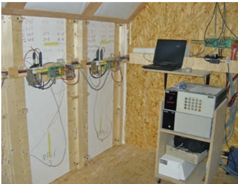
Das Innenleben des Modellhauses wird von einer Vielzahl von Messapparaturen bestimmt. Auf dem Bild sichtbar sind die Rückseiten der Fassadenelemente mit Oberflächentemperatur- und Feuchtesensoren.
