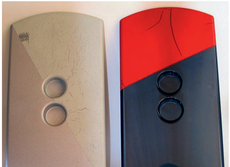
Spannungsrisse durch Lösemittelangriff (2K-PUR-Lack) auf Formteilen aus Polycarbonat.
