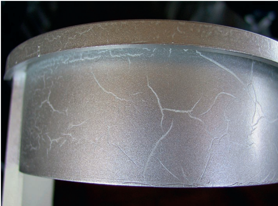
Spannungsrisse durch Lösemittelangriff (2K-PUR-Lack) auf einem Lampengehäuse aus ABS.
