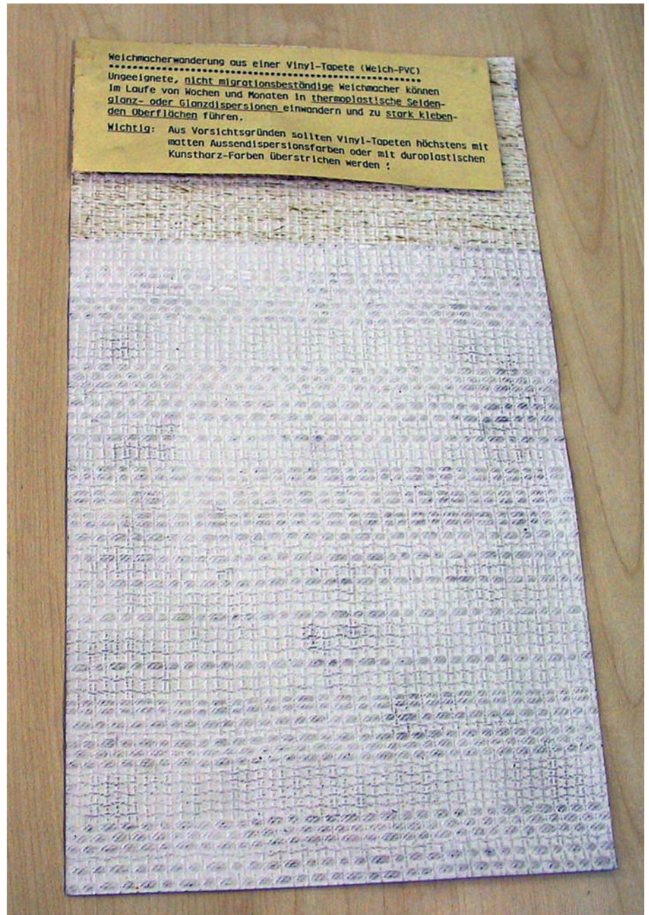
Eine Seidenglanzdispersion auf einer Vinyltapete mit Weichmacher führte hier zu einer klebrigen Oberfläche und zu Verschmutzung.
