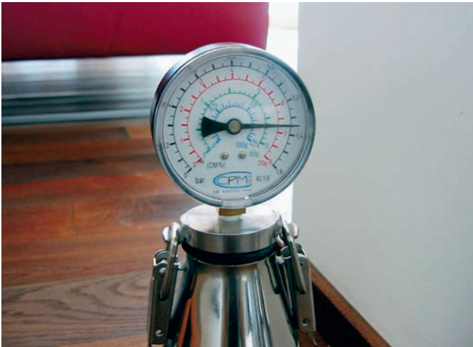
2 Der Druck des in einer Stahlflasche entwickelten Azetylgases ist bei der CM-Feuchtemessmethode ein Maß für die Feuchtigkeit der vermessenen Materialprobe.
