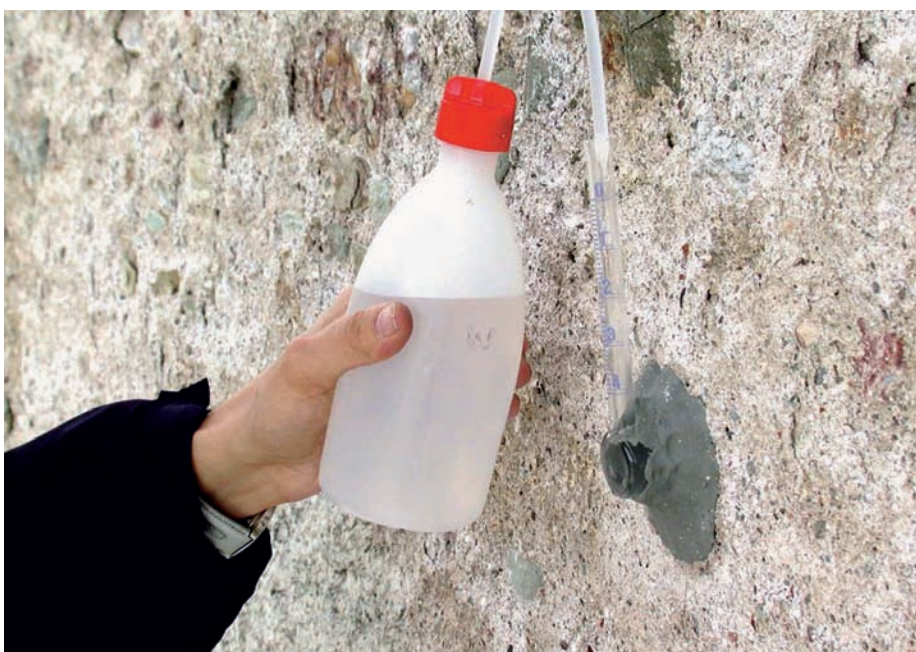
2 Vor Ort lässt sich die Wasseraufnahme eines Putzes mit Hilfe des Karstenschen Röhrchens bestimmen.
