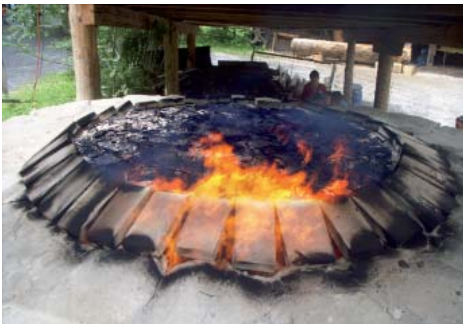
Der Kalkofen brennt. Der durch den Brand entstandene Sumpfkalk wird für den denkmalgerechten Unterhalt verschiedener Gebäude im Freilichtmuseum Ballenberg verwendet.
