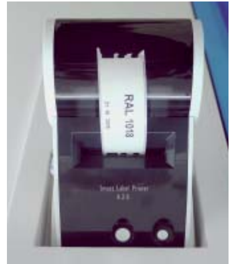
Die Software von Abtönmaschinen speichert nicht nur die Farbrezepturen, sondern erlaubt auch das automatische Drucken von Etiketten mit Farbtoninformationen.
