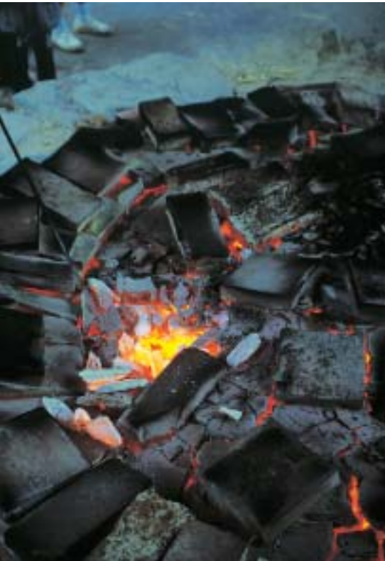
Die Kalksteine glühen. Ein chemischer Prozess setzt ein: Das Kohlendioxid (CO 2 ) entweicht. Zurück bleibt Kalziumoxid (CaO).
