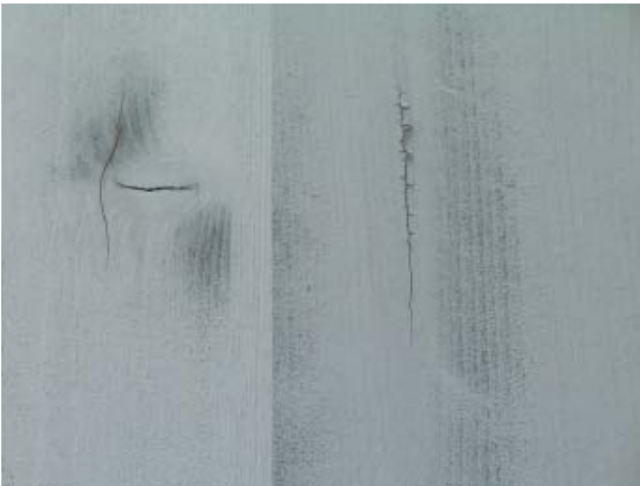
Deutliche Anstrichschäden bei fast deckend lasierter Dreischichtplatte: Rissbildungen und Astdurchschläge. Bei Acrylaufbauten ist ebenfalls mit Verfärbungen und Astdurchschlägen durch Inhaltsstoffe zu rechnen
